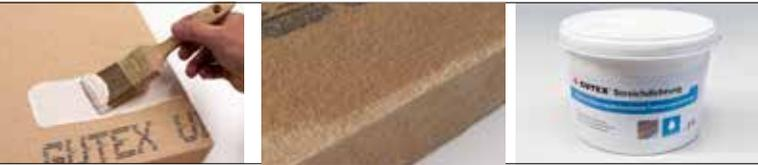
**GUTEX Streichdichtung** ist eine strukturviskose Funktionsbeschichtung mit kapillarbrechendem Charakter. Sie wird als partielle Beschichtung zur Verringerung der Feuchteaufnahme über die Oberfläche der GUTEX Holzfaserdämmstoffe – insbesondere über die Stirnkante – eingesetzt.
