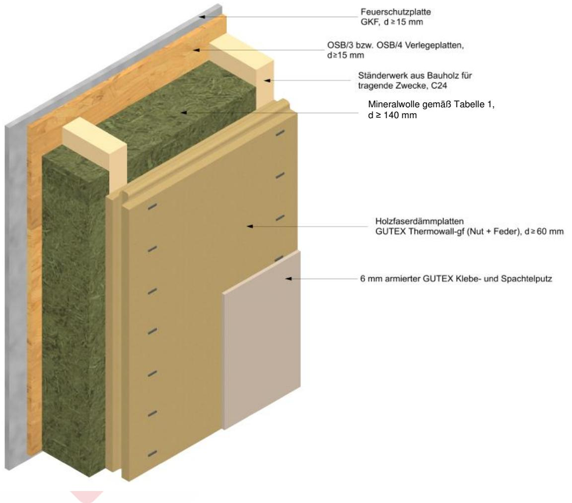
Anlage 5 Detail zur Ausführung der Umhausung für Einbauten
