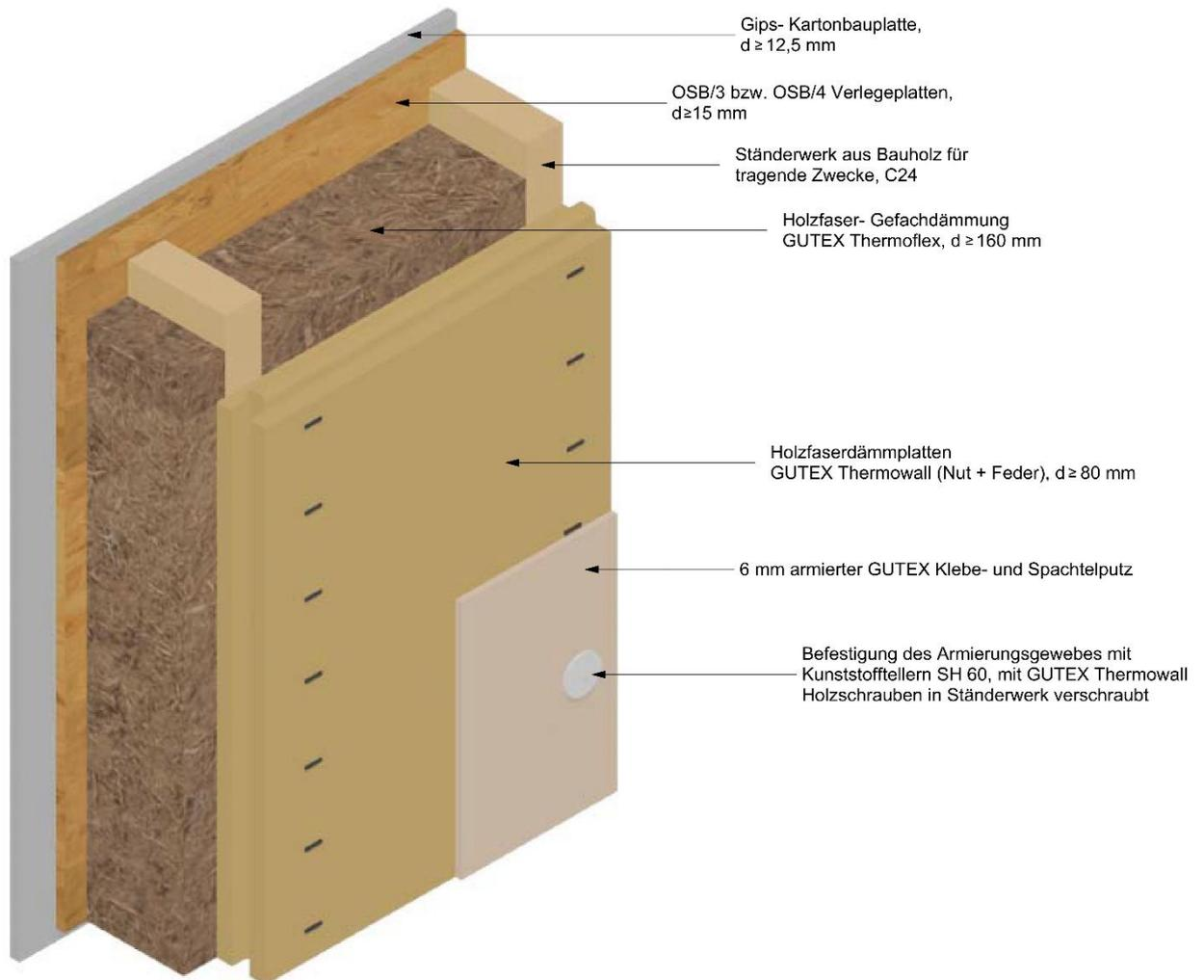
Anlage 4 Konstruktiver Aufbau der Holzständerwandkonstruktion Variante 2, ausgeführt als Gebäudeabschlusswand der Feuerwiderstandsklasse F 60<sub>von Innen</sub> und F 90<sub>von Außen</sub>:
